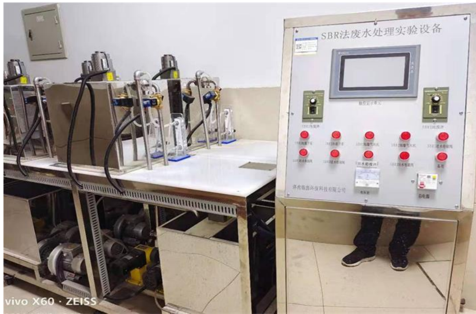
SBR 法废水处理实验设备
