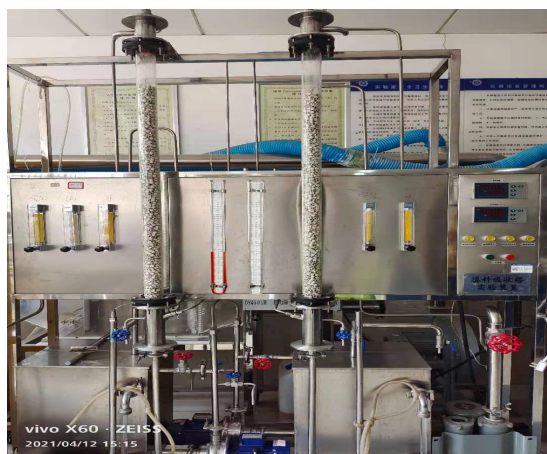
填料吸收塔实验装置
