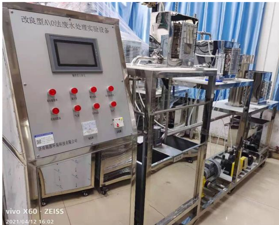
SBR 法废水处理实验设备
