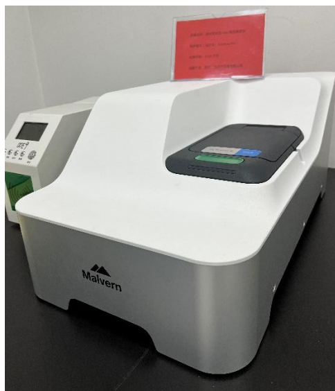
Zeta 电位和纳米粒径测定仪 蛋白质品质控制分析仪
