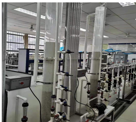
过滤及反冲洗实验装置
