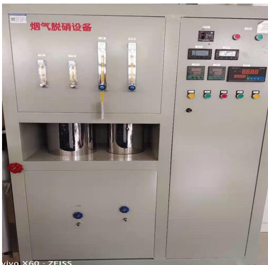
烟气脱硝实验设备
