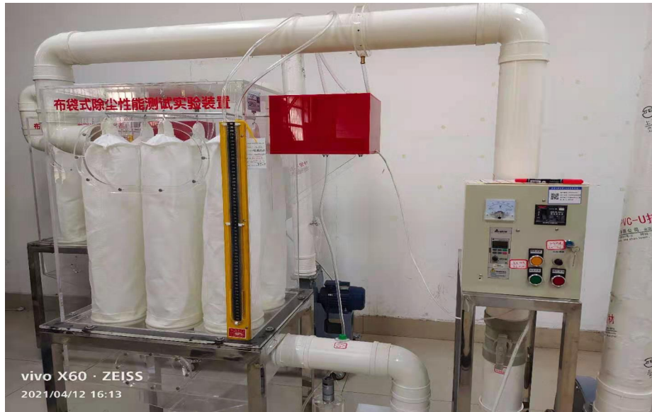
布袋式除尘性能测试实验装置
